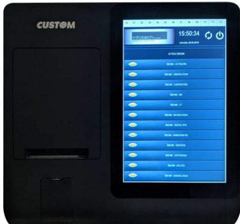
**Centralni displej** - služi za prikazivanje liste svih šaltera i rednih brojeva klijenata koji su sledeći u redu.
